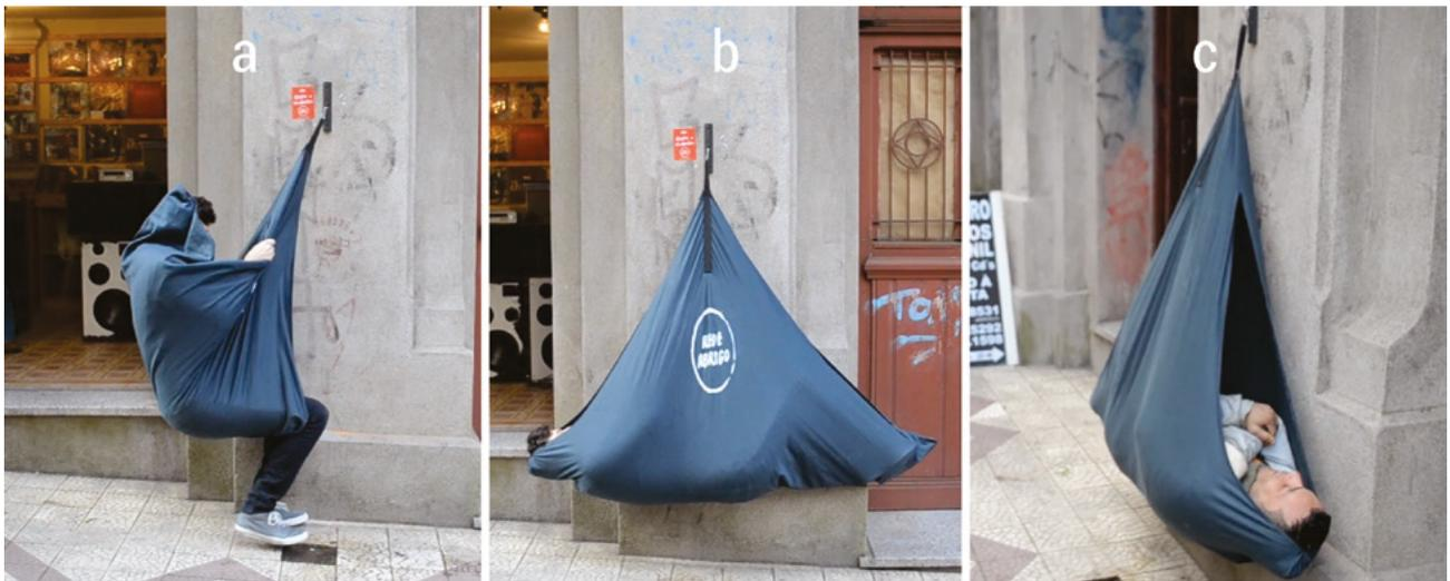
**Figura 2 - Protótipo desenvolvido e teste simulando a utilização da rede de forma efetiva**
